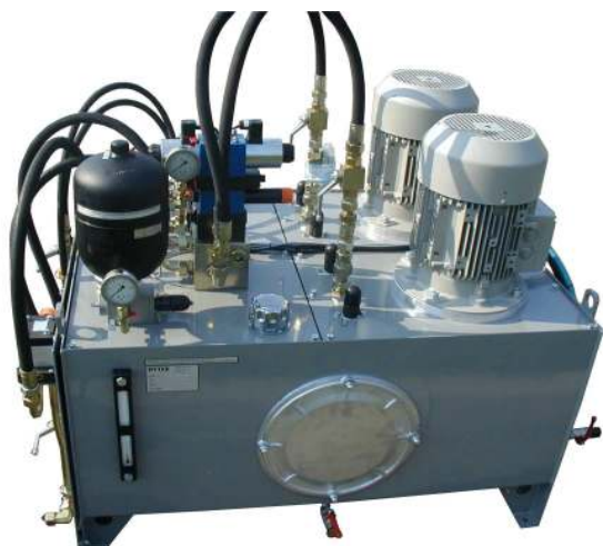
Hydraulický agregát pro regulaci klapky a Hallow-Jetu zakázka Al-Wehdah Jordánsko.
