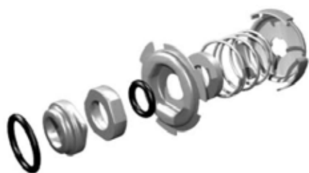
Obr. 13 Konstrukční vyobrazení hřídelové ucpávky
